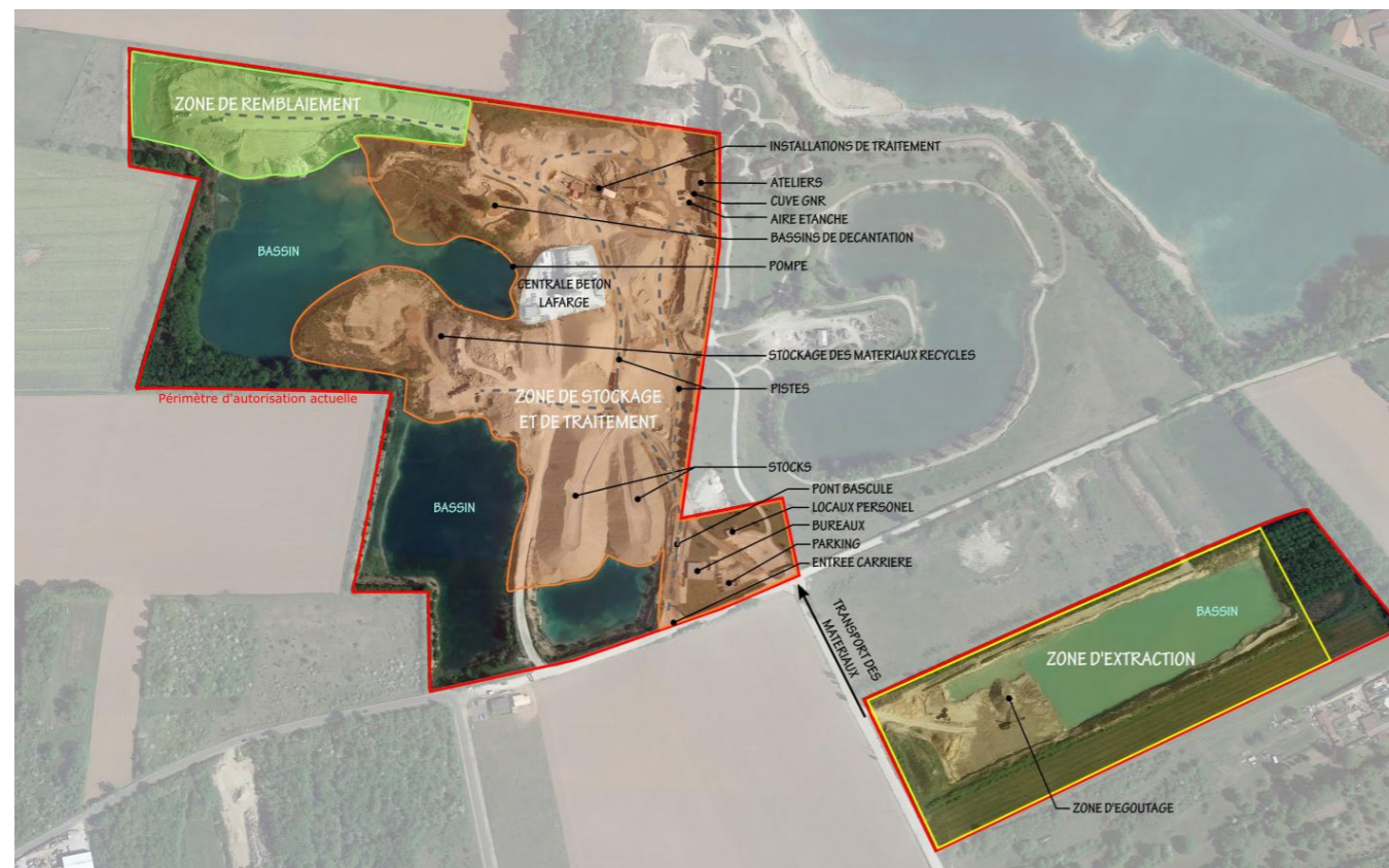
Figure 10. Schéma de fonctionnement de la carrière actuelle. Source MICA ENVIRONNEMENT
